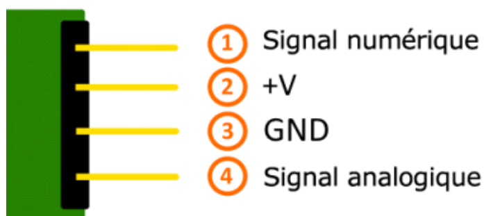
Fig 2.7 Brochage d'un détecteur de flamme
