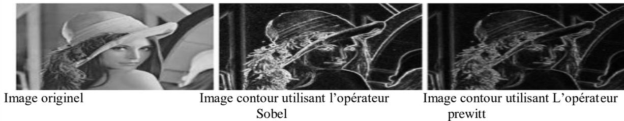
Figure 1.7: exemple de détection de contour en utilisant les opérateurs de sobel et prewitt.
