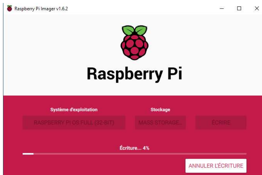
Figure 2-5 : Flasher la carte SD avec Raspbian.
