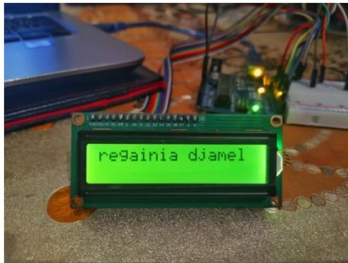
Figure 4.52 Test d'affichage sur LCD.
