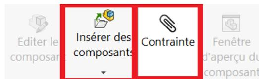
Figure 4.30 Outils d'insertion et de contrainte entre les composants.
