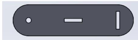
Figure 4.26 Segment de fixation de l'organe terminal.
