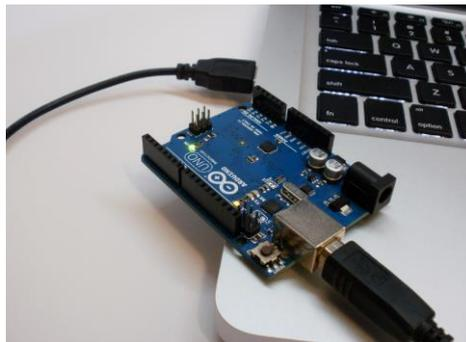
Figure 2.9 Liaison de la carte Arduino à l'ordinateur via le câble USB.
