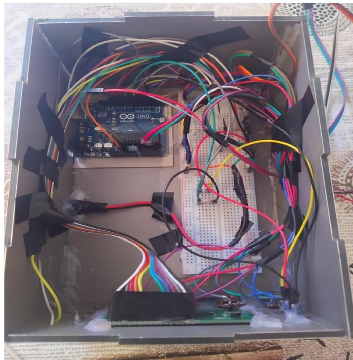
Figure 4.54 Câblage électrique du le robot manipulateur
