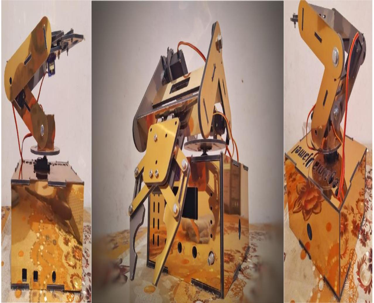
Figure 4.41 Assemblage final du bras manipulateur.
