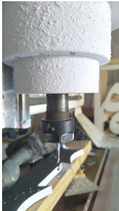
Figure 4.36 Fraise du Fraiseuse.
