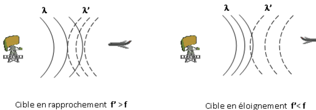
Figure I. 8 : Effet du mouvement de la cible sur les formes d'onde équiphases réfléchies
