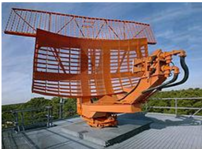
Figure I. 15 : Radar primaire typique à faisceau plat d'un aéroport
