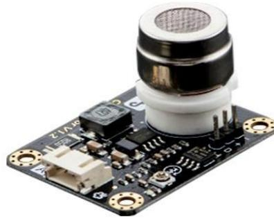
**Figure II.4 : Capteur CO2**
