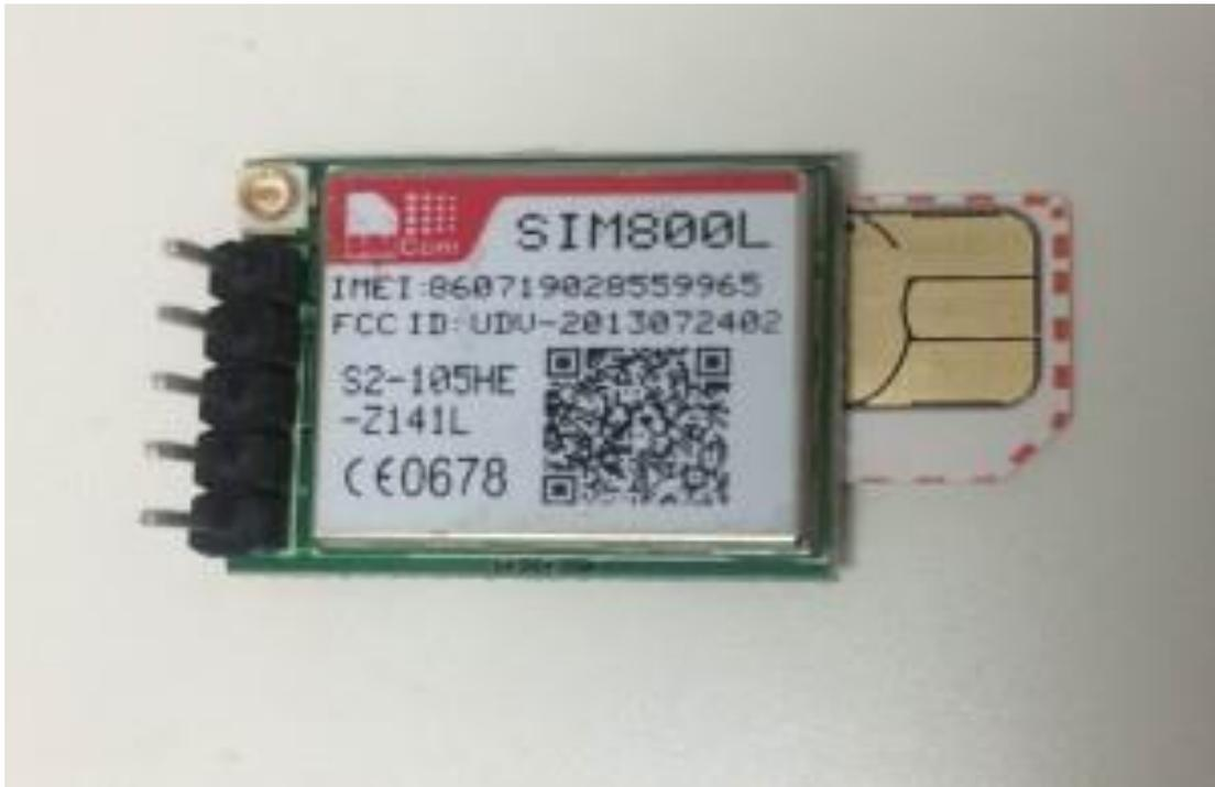
Figure 13 : insertion de la carte Sim dans le module
