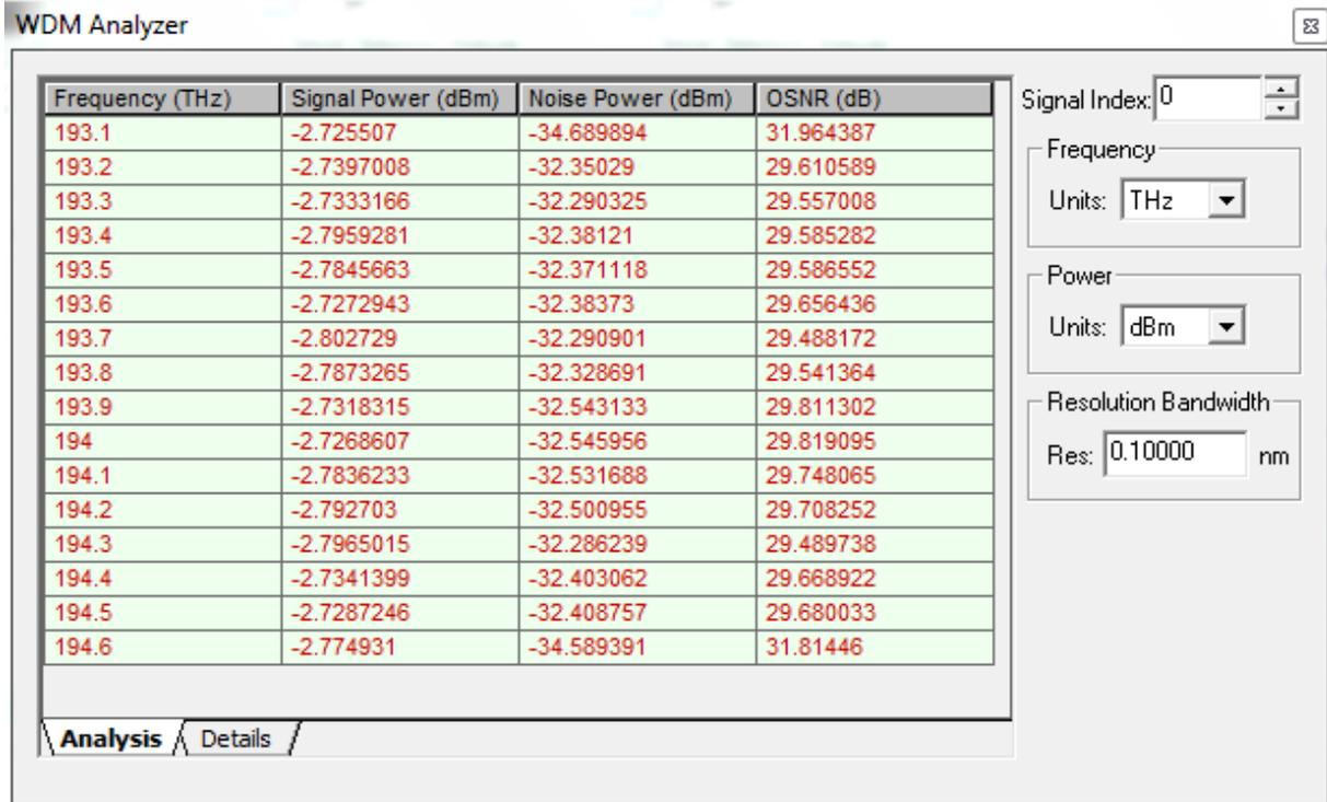
**Figure 3.3 :** Les différentes valeurs des canaux obtenues à la sortie du multiplexeur.
