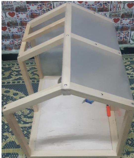
Figure VI.21: La structure de notre serre prototype.
