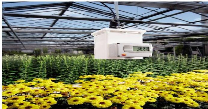
**Figure III.5 :** Transmetteur d'humidité testo 6631
