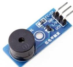
Figure 4 : buzzer (passive modèle)
