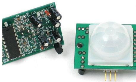
Figure 3 : Détecteur de mouvement infrarouge PIR
