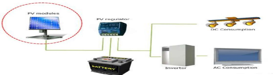
Figure 1.8 : Les composants d'un système PV [5]
