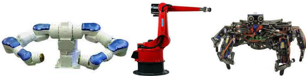
Figure 1.1 : quelques robots industriels (poly articulés, hexapode, double bras)
