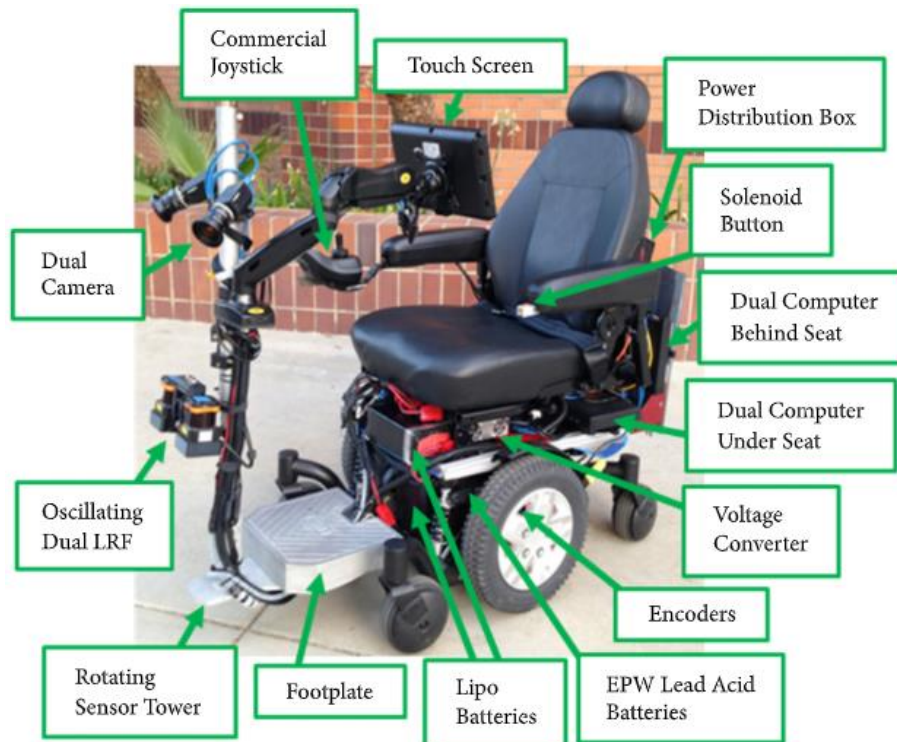
Fig 6 : Constituants d'un FRE intelligent
