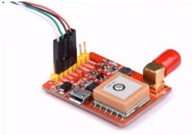
Figure 31: module GPS
