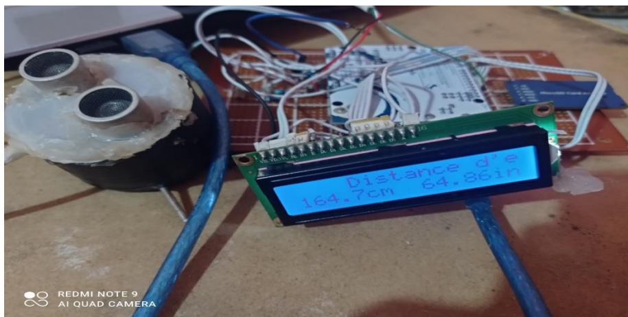
Figure 17 : HC-SR04 et LCD16*2.
