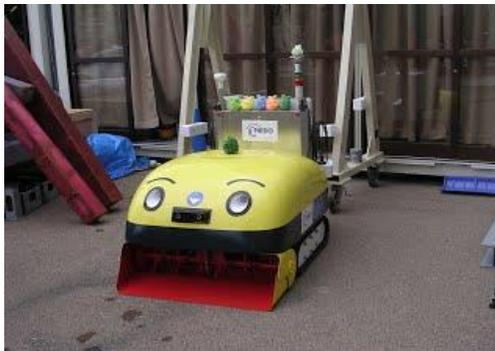
**Figure 1-1.** Un robot engouffrant la neige de la rue avec sa « bouche ».
