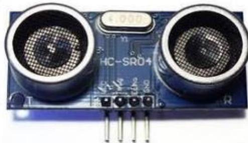
**Figure 2-16** : capteur Ultrason HC-SR04
