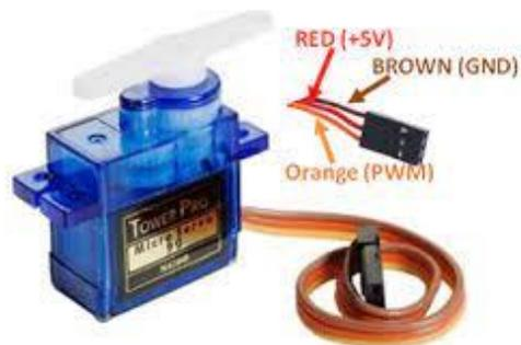
**Figure 2-5** : Servomoteur SG90
