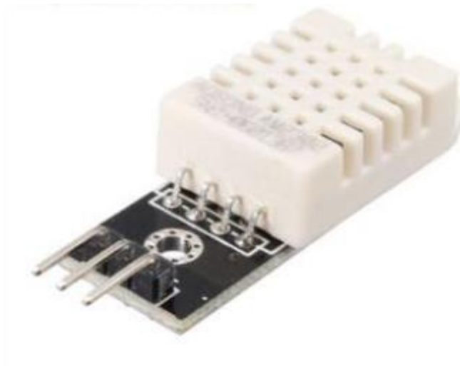
Figure II.6 : Capteur de température et d'humidité DHT22.
