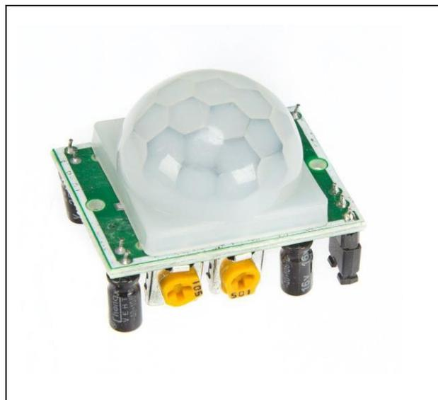
*Figure 11: Capteur de mouvement PIR*
