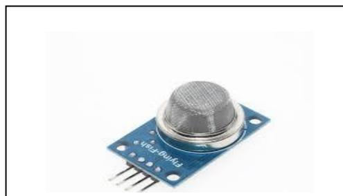
*Figure 8: Capteur de Gaz MQ2*
