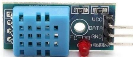
Figure 2.5: Capteur de température et humidité ambiante DHT11
