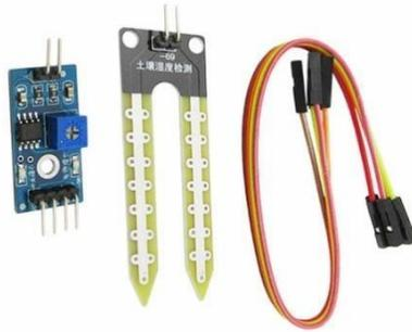
Figure 2.4 : Capteur humidité de sol yl-69
