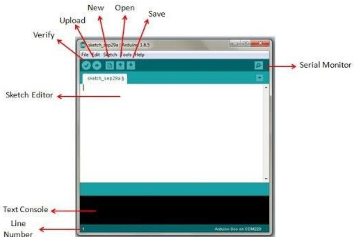
Figure 2.9 : Interface de Arduino IDE
