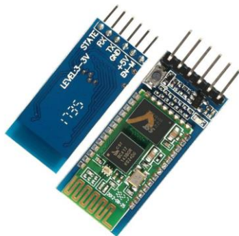
Figure 35 : Le module Bluetooth HC-05
