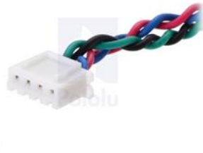
Figure 24 : Le connecteur JST XHP-4 qui termine les fils du moteur pas à pas NEMA 17
