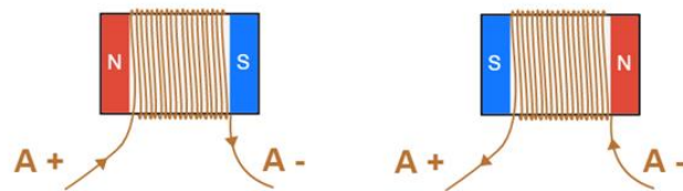
Figure 19 : Direction du champ magnétique en fonction de la direction du courant de la bobine
