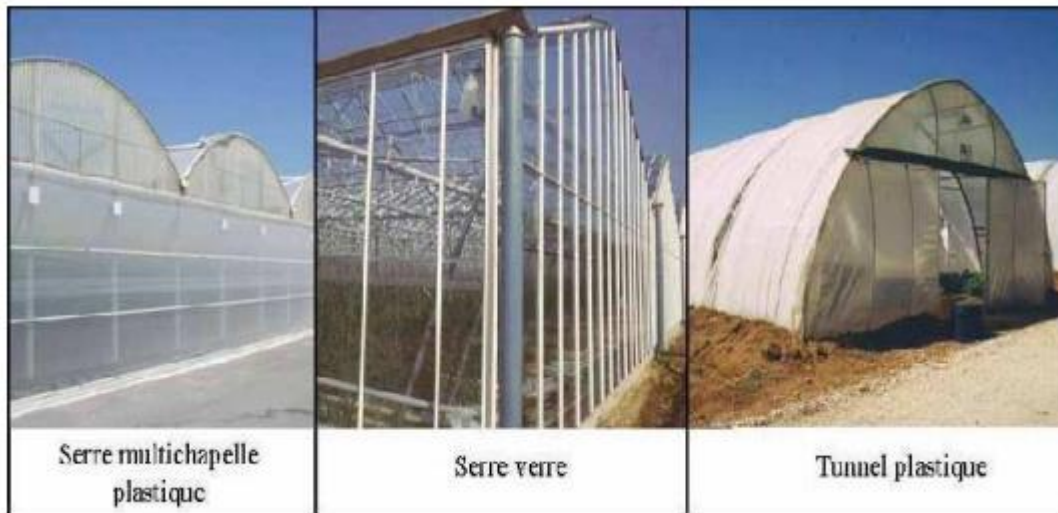
Figure 2: Les trois principaux types de serres
