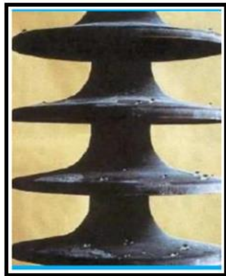
Figure II.19 : Vieillessement d'un Isolateur composite.
