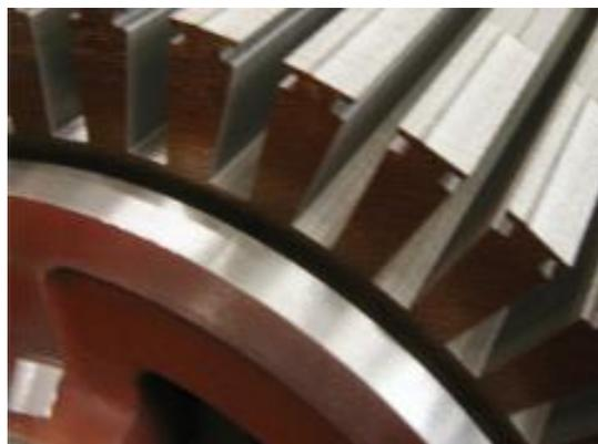
**Figure (I-05) :** Encoche sur l'induit destinée à recevoir les conducteurs.
