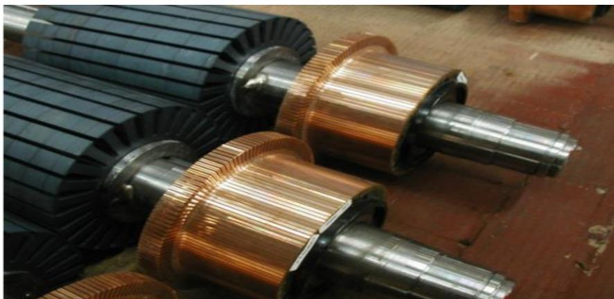
**Figure (I-07) :** Collecteur d'une machine à courant continu de forte puissance.
