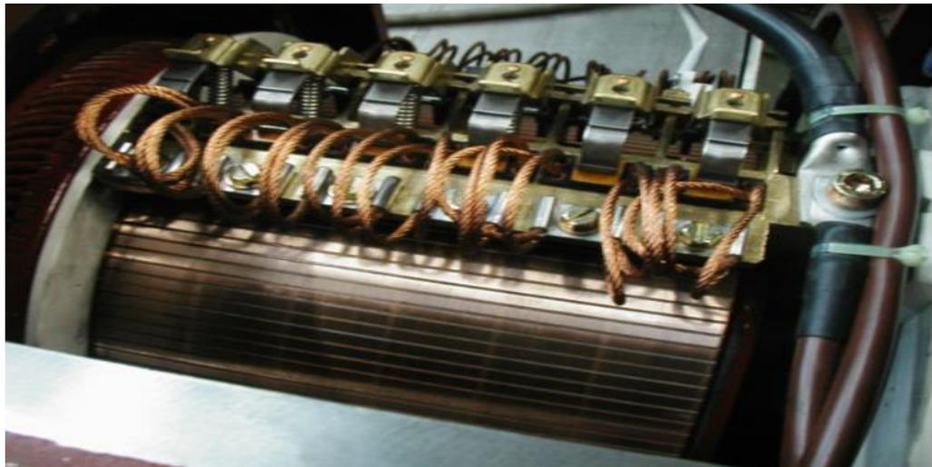
– **Figure (I-08) :** Détails de la ligne des balais d'une MCC de forte puissance
