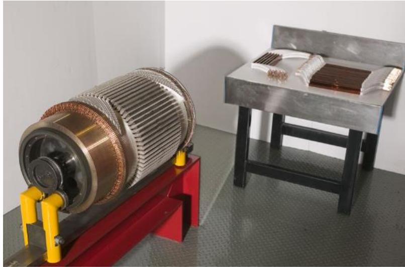
**Figure (I-06) :** Mise en place des conducteurs d'induit dans les encoches
