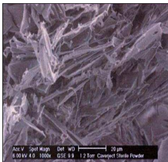
Figure 18. La forme de lyophilisat captée par un MEB (microbillage électronique à grandissement × 1000) au cour de lyophilisation.
