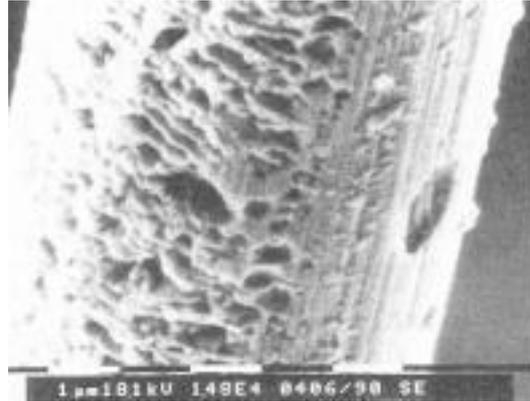
**Figure (III.14)** : Piqûres en surface d'une fibre de carbone, après hydrolyse des aiguilles d'Al<sub>4</sub>C<sub>3</sub>
