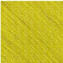
Souvent appelée KEVLAR, la fibre d'aramide est issue de la chimie des polyamides aromatiques. Il est possible de trouver deux types de fibres d'aramide de rigidités différentes :
