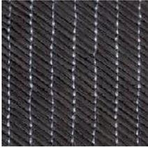
C'est la fibre la plus utilisée dans les applications hautes performances. Elle est obtenue à partir de PAN (PolyAcryloNitrile) ou à partir de Brai.
