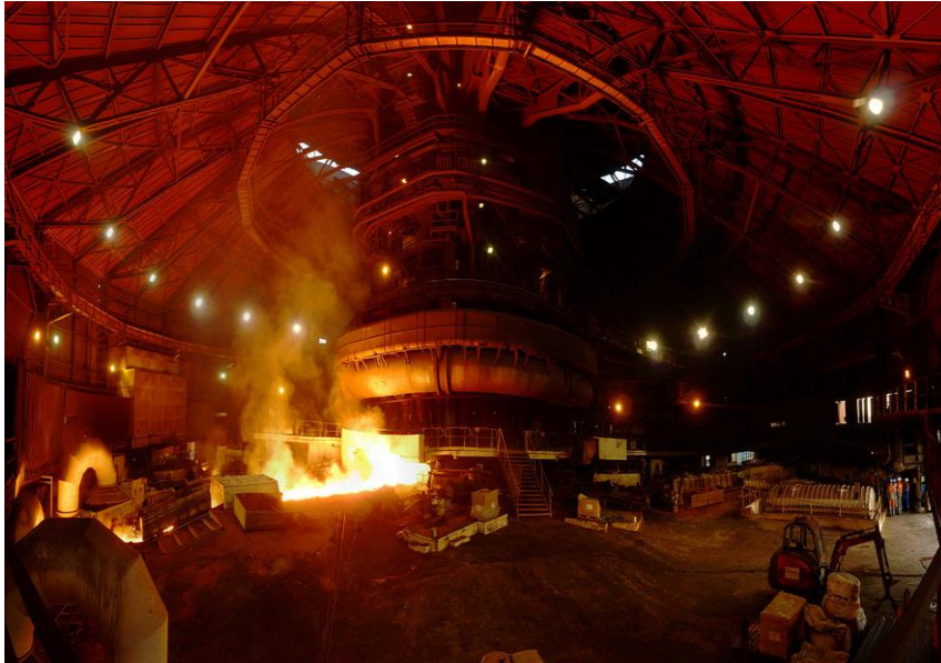
Figure II.2- Photo panoramique d'une coulée au haut fourneau
