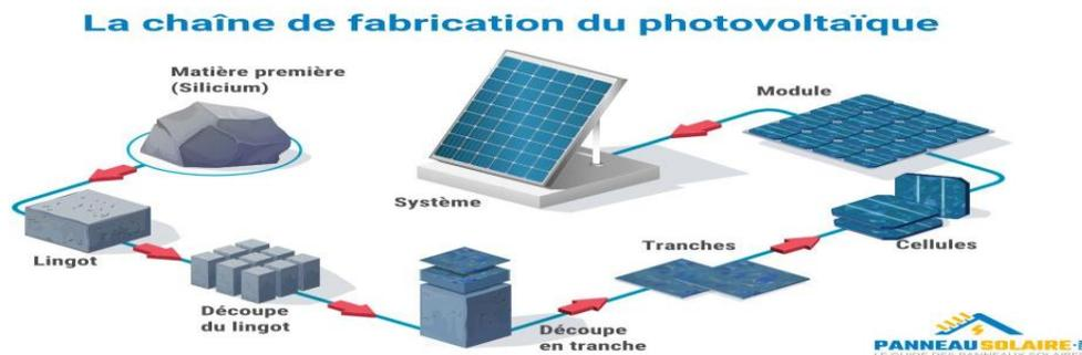
Fig. 2.5 Fabrication d'un system. PV
