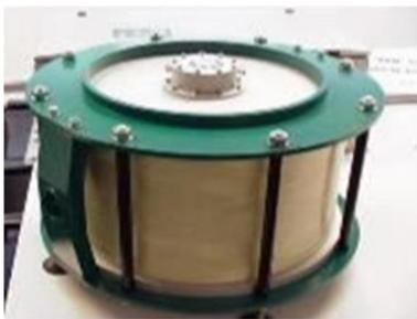
(a) Volant d'inertie du tramway
