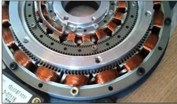
FIG II.4 – MRV à effet Vernier à stator externe et interne [30]
