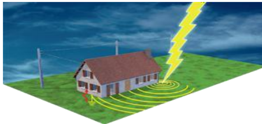
Figure I– 12 : La remontée de terre [4].
