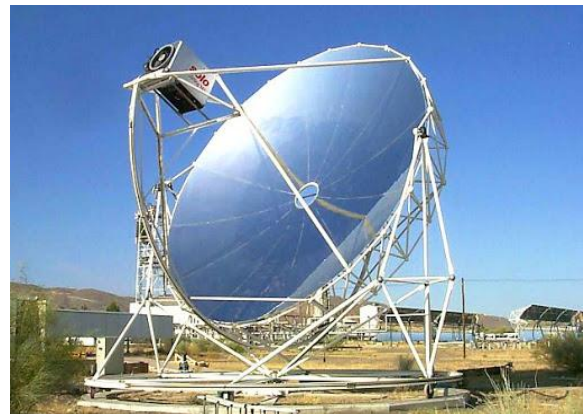
Capteurs thermodynamique paraboliques
