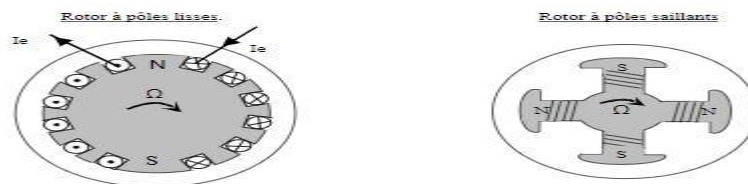
Fig.I.19 Types des rotors de la machine synchrone à rotor bobiné.
