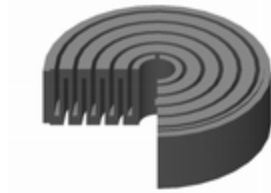
Figure II-9 :Schéma d'un échangeur à bloc complexe [11]
