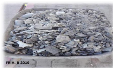
Figure 28 : les mâchefers récupérés après l'incinération [16]
