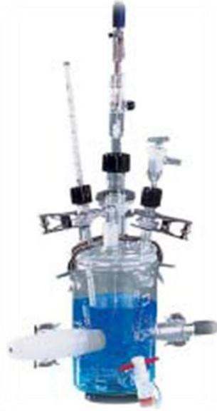
Fig.II.4 - Cellule électrochimique à trois électrodes
