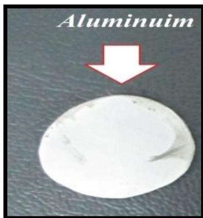
Fig. .II.1 - Électrode de travail utilisé dans les essais électrochimiques
