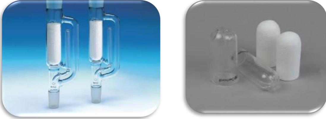
**Figure VI.8 : Cartouche en cellulose placer dans un extracteur (soxhlet)**
