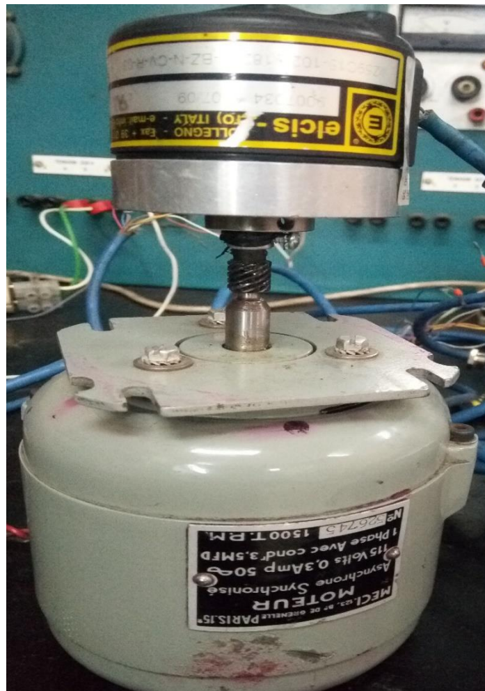
Fig. 27 Commande d'un moteur asynchrone par encodeur
