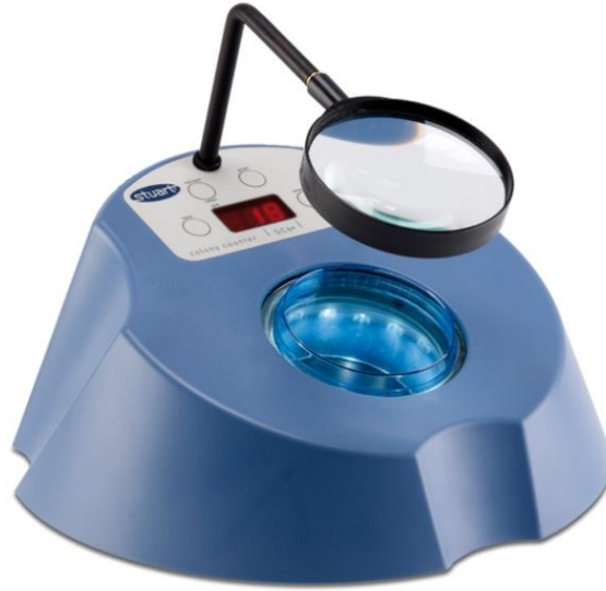
Figure V.3. Compteur de colonies utilisé au laboratoire d'analyses microbiologiques à Sidal Constantine 02.
