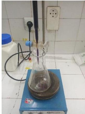
**Fig.IV.4. Protocol du dosage d'ions de  $\text{Fe}^{2+}$**
