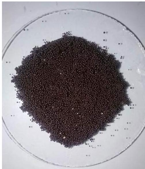
**Fig.IV.1 l'image de la résine « Purolite C160S »**
