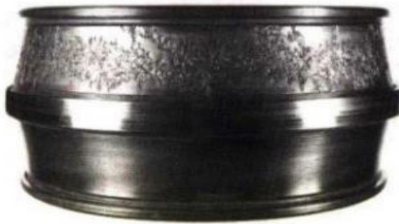
Figure II.19 : Défaut de roulement – écaillage. [15]
