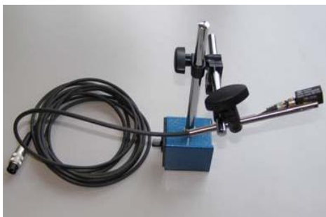
Figure.III.7 : Capteur de référence avec rotation support magnétique. [23]
