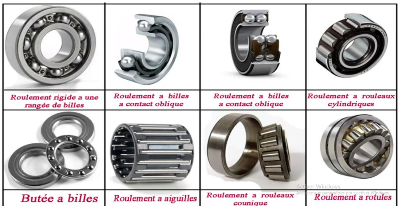
Figure II.14 : Différents types de roulements. [15]
