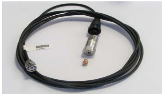
Figure .III.6 : Capteur de mesure avec câble de raccordement. [23]
