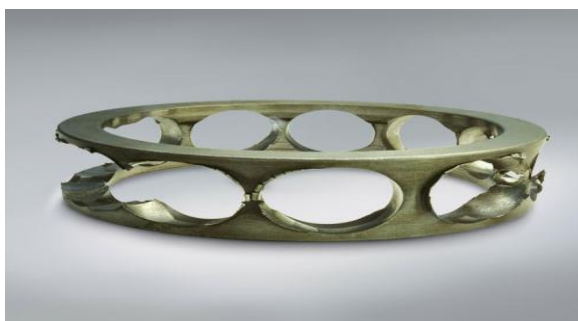
Figure II.17 : Défaut de roulement - Rupture de la cage.[18]
