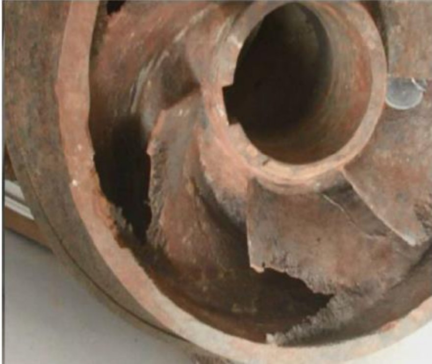
Figure (1-21) : les dégâts subis par une pompe
