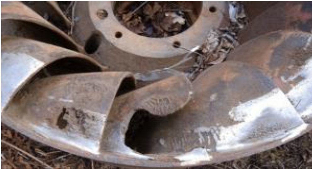
Figure (III-7): Vue d'une roue soumise aux dégâts de cavitation
