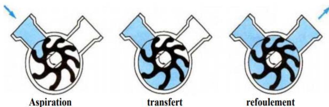
Figure (I-13): pompe à palette flexible
