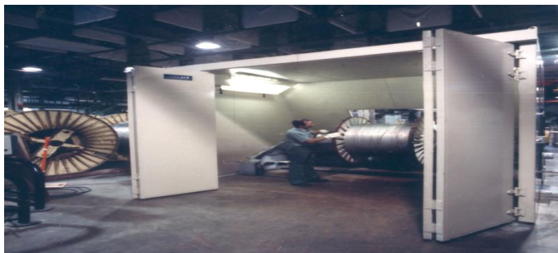
Figure. V.5. Encoffrement de l'intérieur pour machine. [64]
