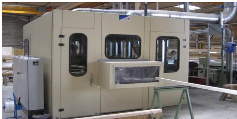
Figure. V.4. Encoffrement de l'extérieur. [63]
