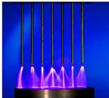
Figure 3.5 : Photographie d'une décharge corona multi-pointes [31]
