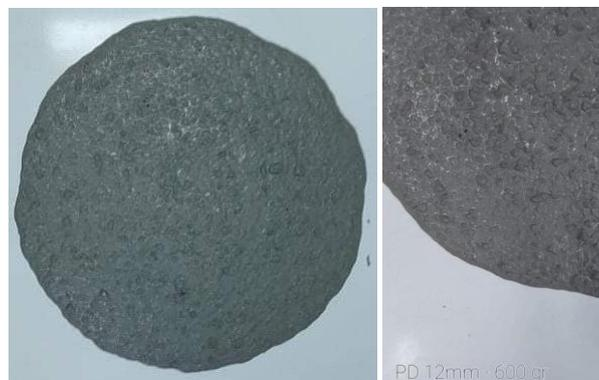
**Figur III.6.** Etalement d'un BAP PD 12( mm) retenue.
