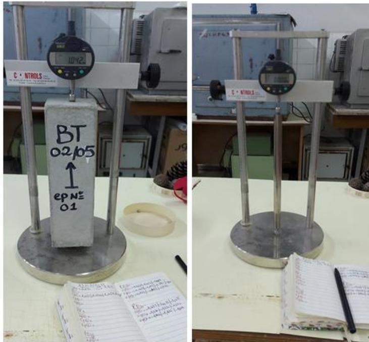
Figure. II.15 : Essai de retrait réalisé au laboratoire.
