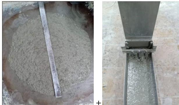
**Figure III.4 :** étalement de formulations N° 04 non acceptables
