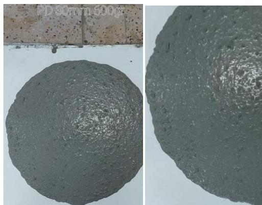
**Figure.III.8.** Etalement d'un BAP Palmier Dattier 30 (mm).
