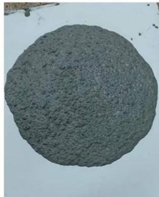
**Figure III.5 :** étalement d'une des formulations BAP PP
