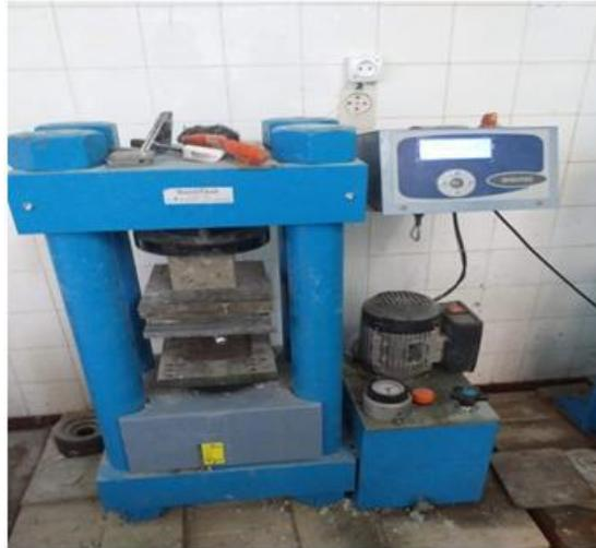
**Figure II.12** : Essai de compression.
