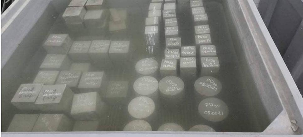
**Figure. II.8 :** Conservation des éprouvettes pour les essais mécaniques.
