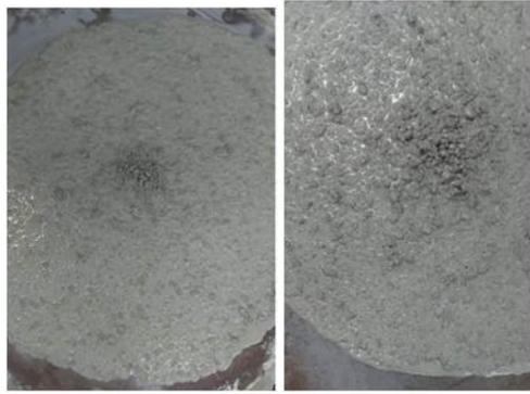
**Figure III.1** : Etalement des formulations avec ségrégation BAP non valide.
