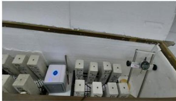
**Figure. II.14.** Conservations des éprouvettes pour essais de retrait.
