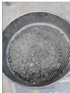
**Figure III.2** : stabilité de tamis de la formulation N°07.
