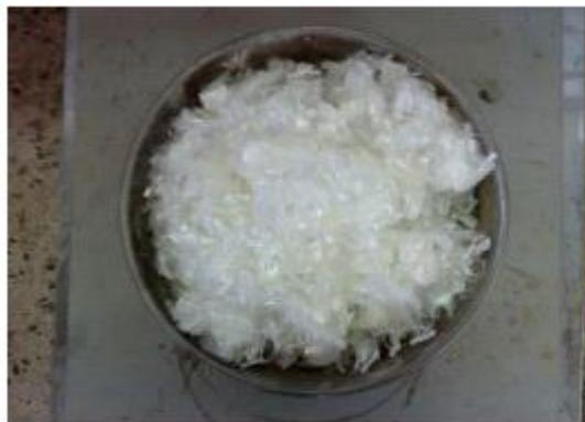
**Figure I.16:** Fibres de polypropylènes
