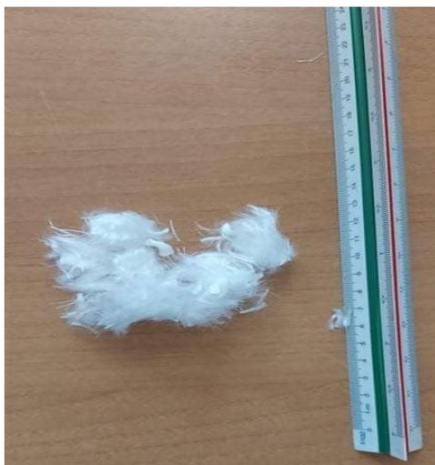
**Figure II.1** : Fibres de polypropylènes
