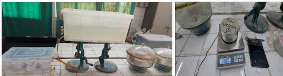
**Figure II.17 : Essai d'absorption par capillarité.**
