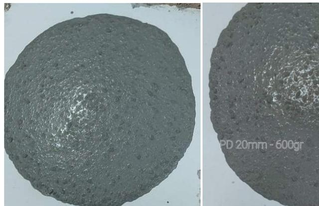
**Figure III.7.** Etalement d'un BAP PD 20 (mm) retenue.
