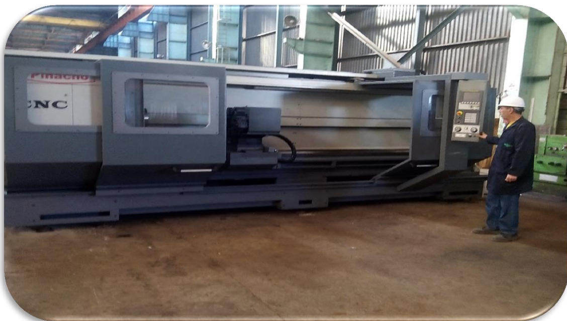
TOUR PARALLELE PINACCHO A Commande numérique 4000 mm avec un mandrin de 500 mm de diamètre
