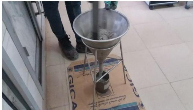
*Figure II.9 : Mesure de la masse volumique apparente.*
