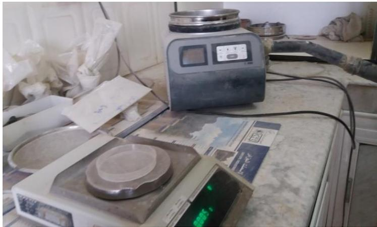
*Figure II.7: Tamiseuse à jet d'air ALPINE.*
