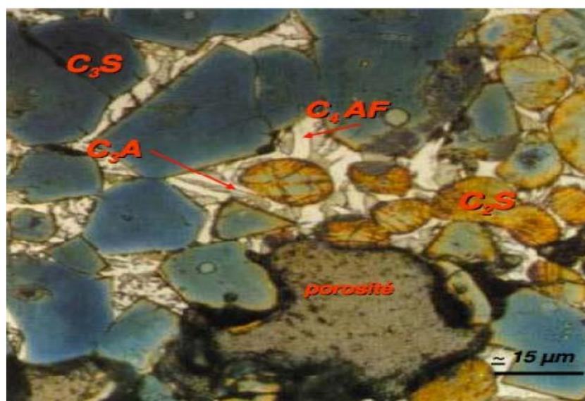
**Figure I.2:** Clinker observé au microscope optique [Ludovic Zingg, 2013].
