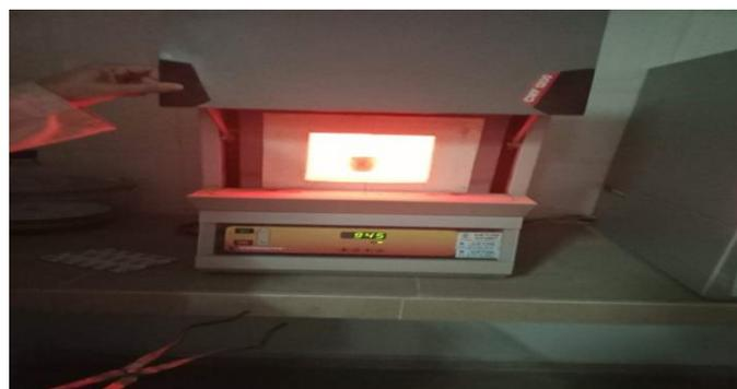
*Figure II.14 : Four à calcination*
