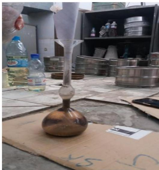
*Figure II.8 : pycnomètre Le Chatelier.*
