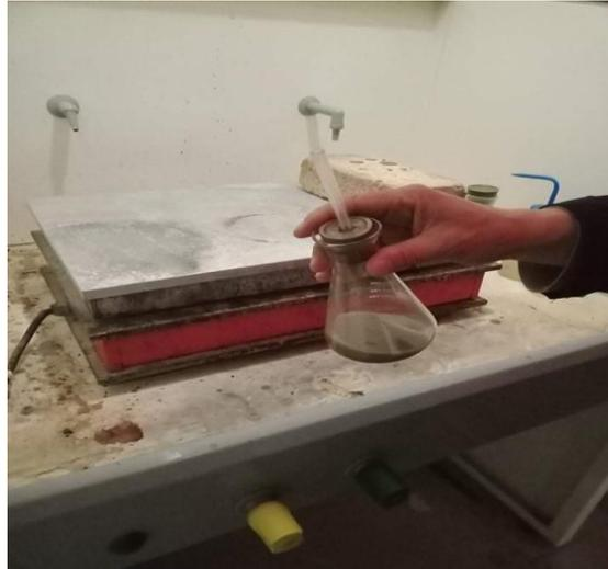
*Figure II.18 : Détermination de la chaux libre*
