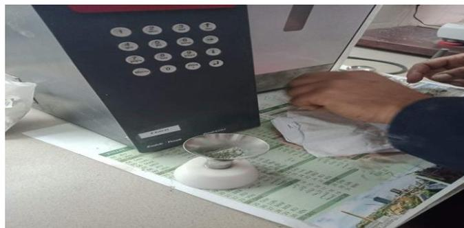
*Figure II.10 : Mesure de la surface spécifique de Blaine.*
