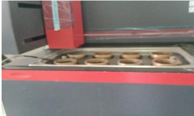
*Figure II.12* mesure de début et fin de prise
