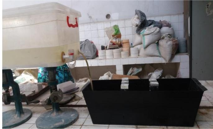
Figure II.17: L'essai d'absorption capillaire
