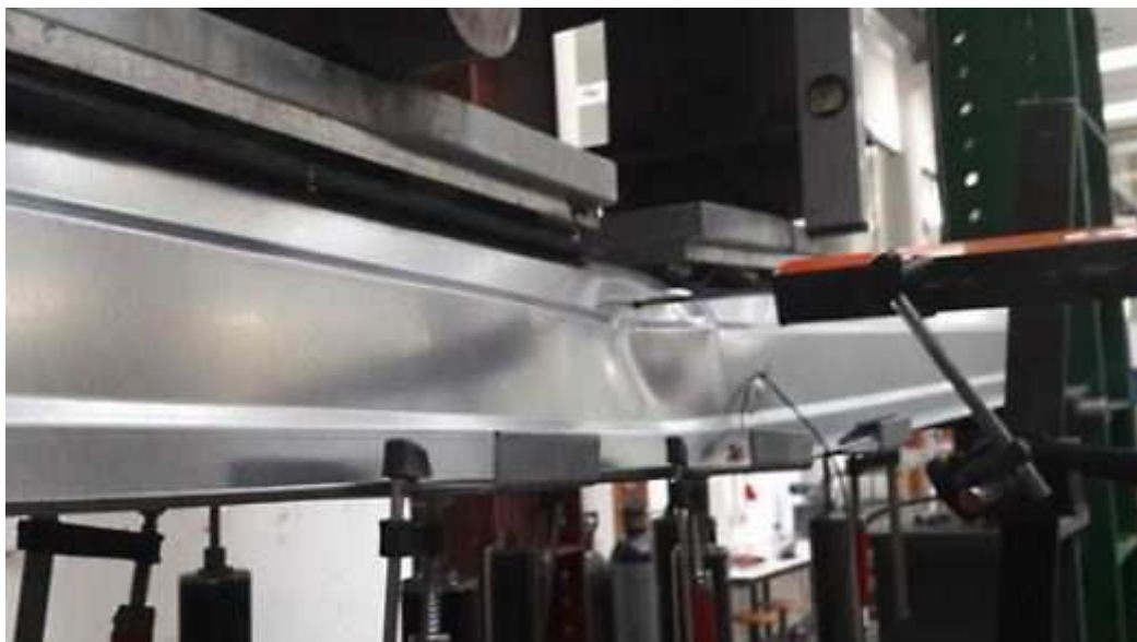
Figure I- 29: voilement locale de la poutre super-oméga
