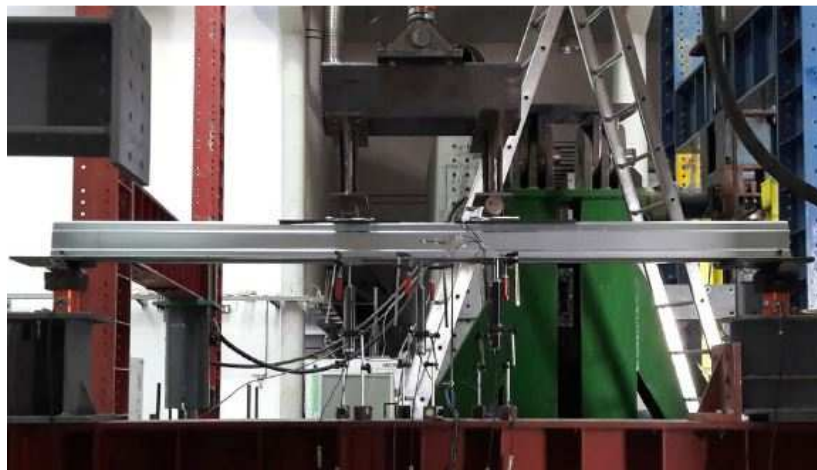
Figure I- 27 : Essai sur le modèle de poutre super-oméga.
