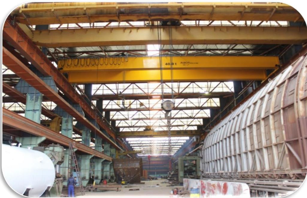
Figure 1.8 : Moyens De Levage Et De Manutention (Ponts Roulants)
