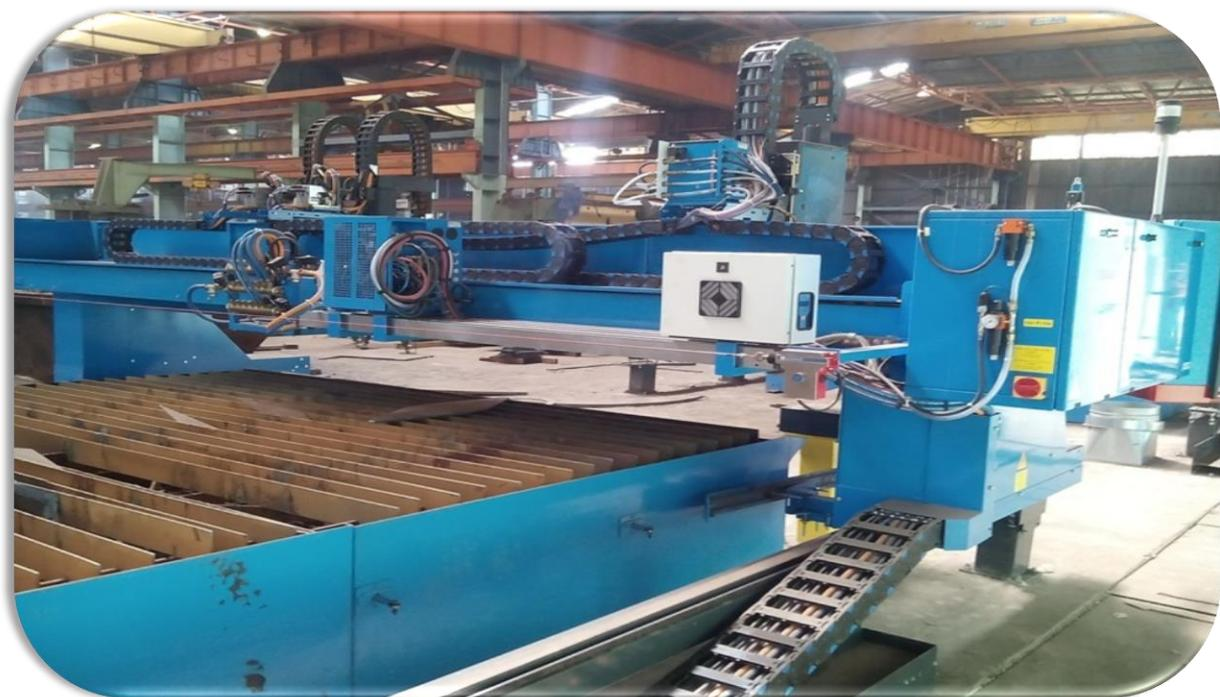
**Figure 1.5 : Table De Decoupe Oxy Plasma**
