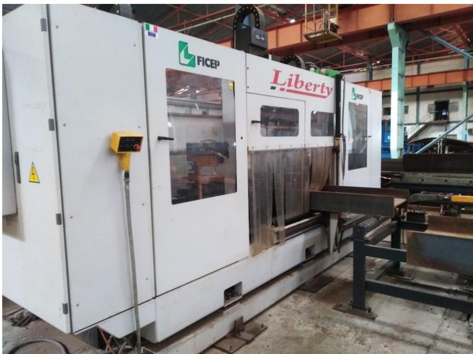
**Figure 3.1** : représente la machine de perçage (liberty)
