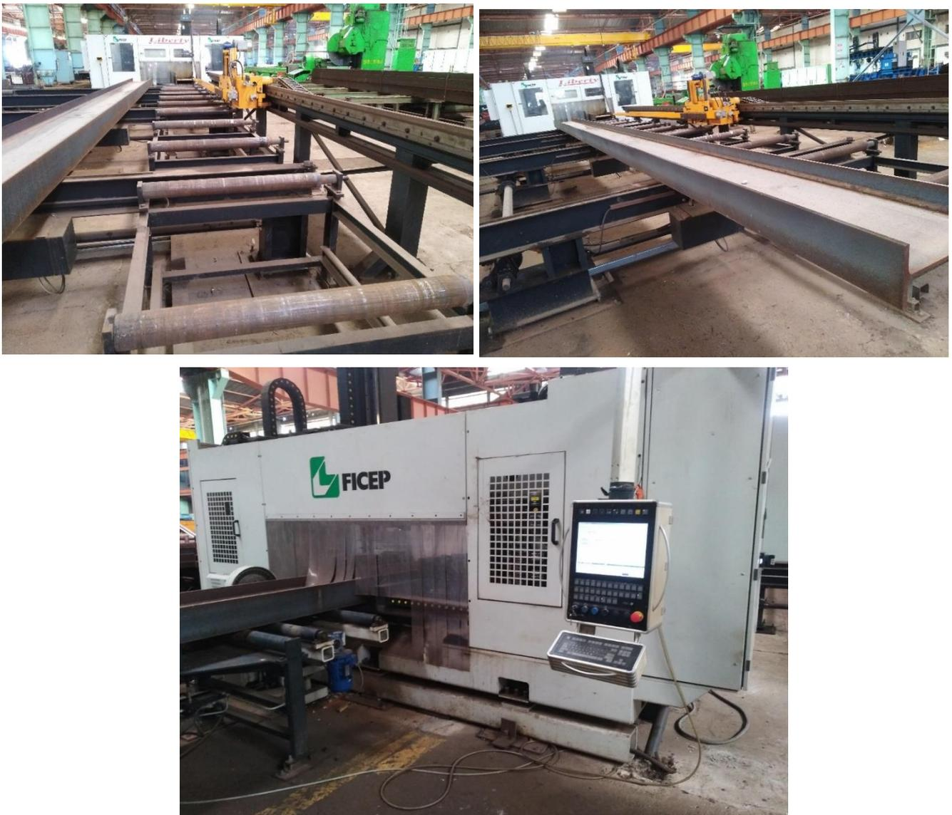
**Figure 3.3 :** représente Voie à rouleaux, Motrice avec pince, marqueuse a écriture
