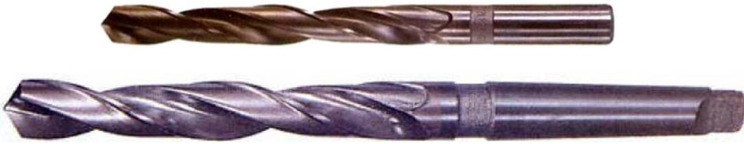
Figure 2.2 : : Foret à queue cylindrique et Foret à queue conique.
