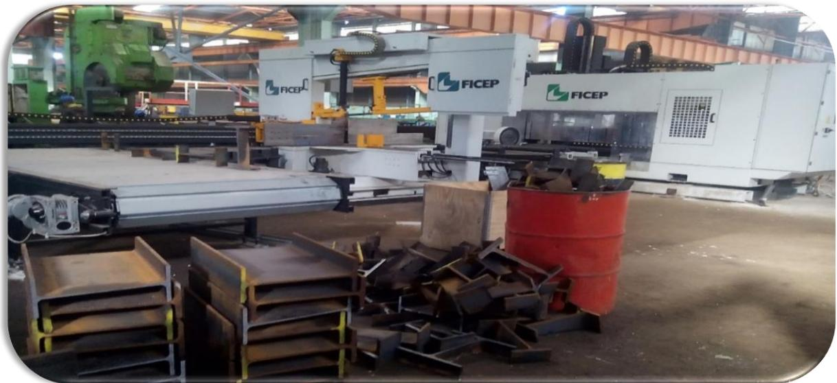
**Figure 1.6 :** Ligne De Production Automatique De (Perçage)
