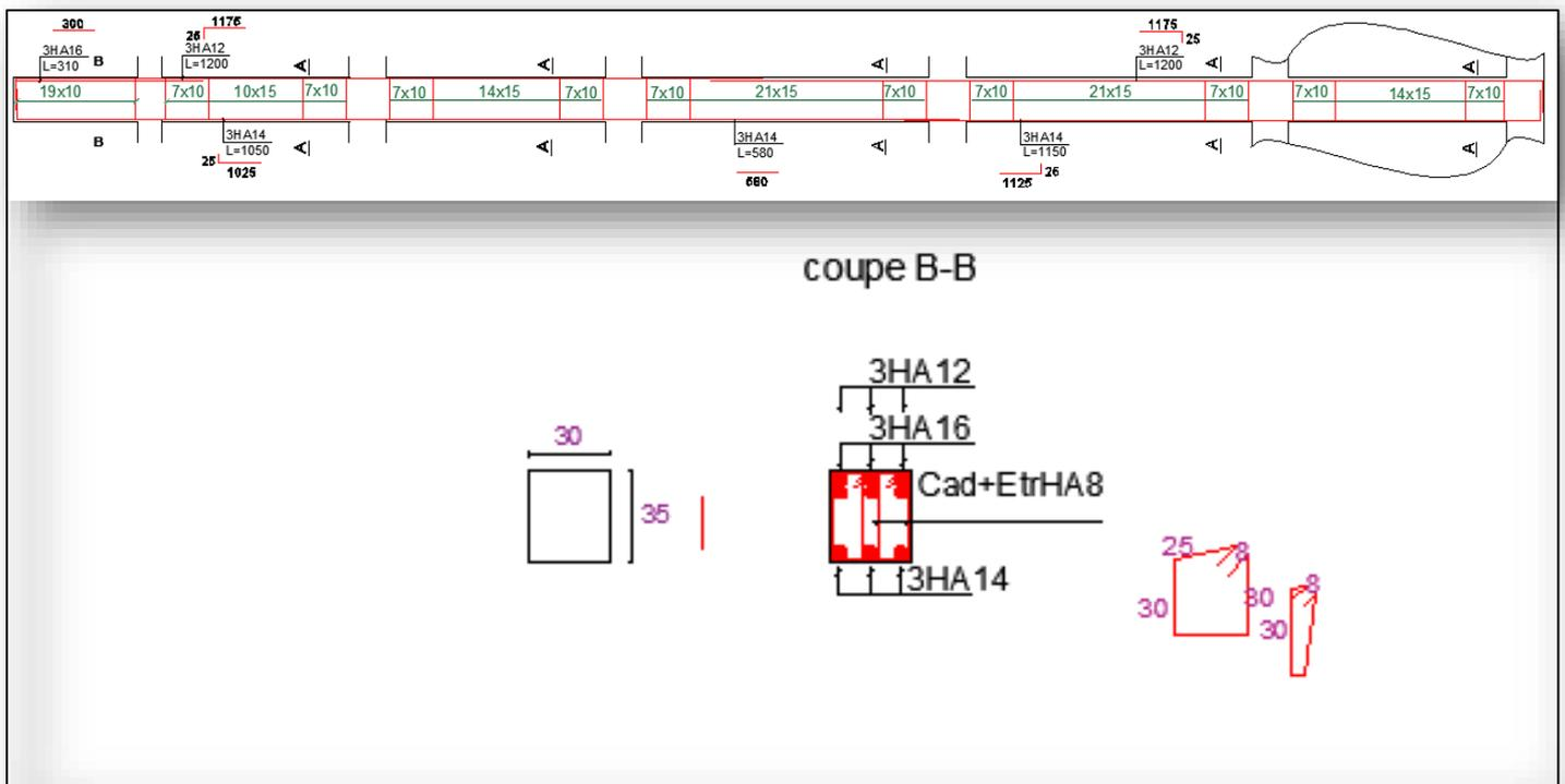
Figure IV.10: Ferrailage poutre secondaire RDC
