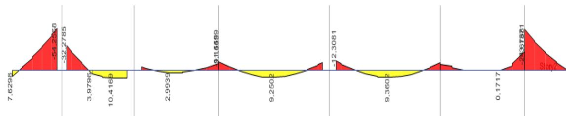
**Figure IV.3** : Diagramme des sollicitations dans les poutres secondaires (étage courant).
