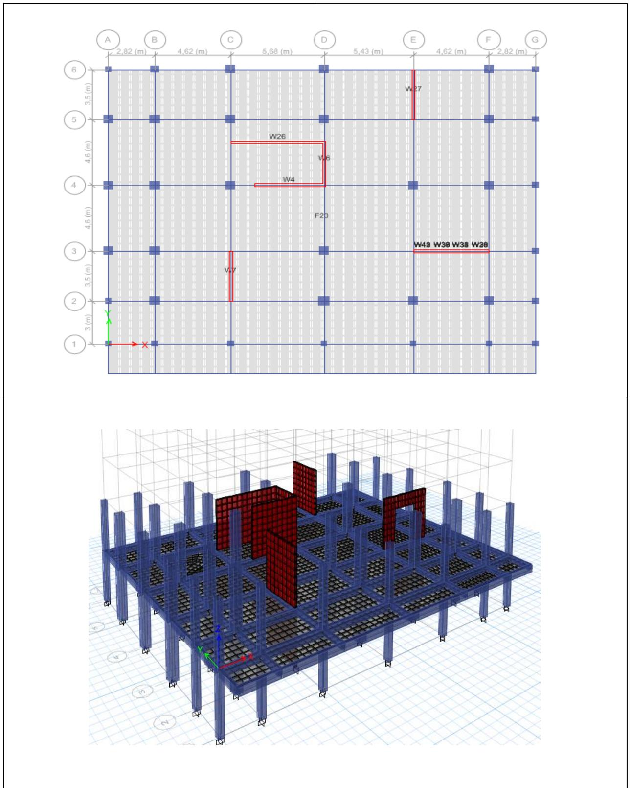
Figure III .1 : Disposition des voiles.
