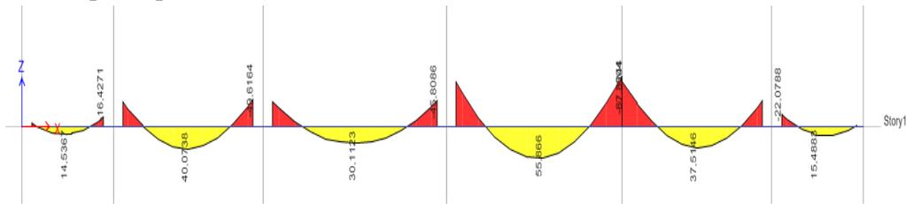
**Figure IV.2** : Diagramme des sollicitations dans les poutres principales (RDC).
