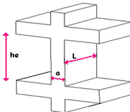
**Figure II.6** Coupe transversale d'un voile.
