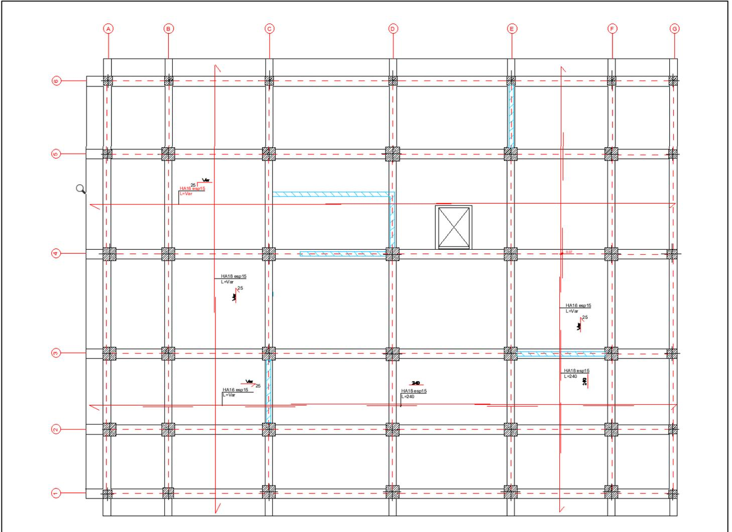
Figure VI.4 : Ferrailage nappe supérieure et nappe inférieure.
