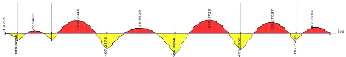
**Figure VI.7 :** Diagramme moment fléchissant dans l'axe 5
