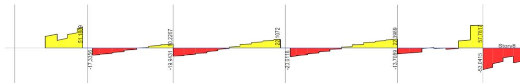
Figure IV .6 : Diagramme des efforts tranchants dans les poutres.
