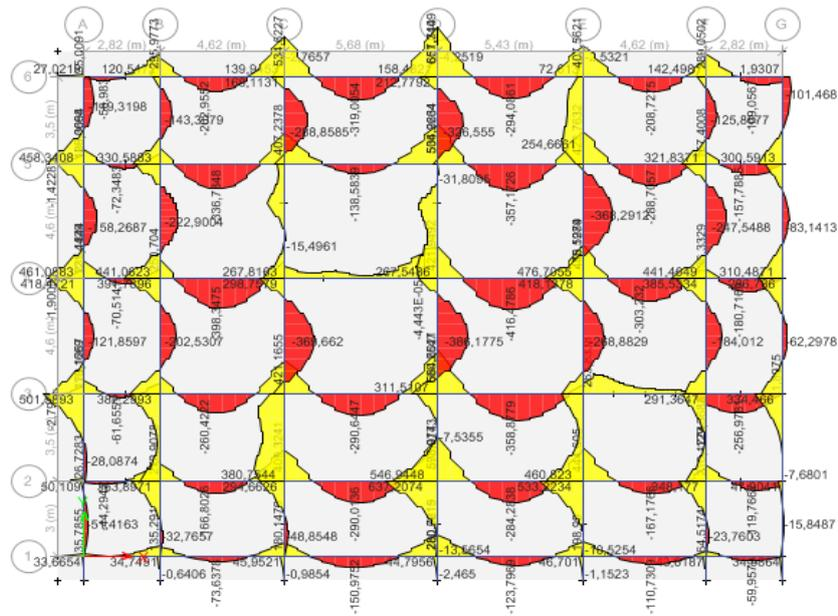
**Figure VI.6 :** Diagramme moment fléchissant des nervures
