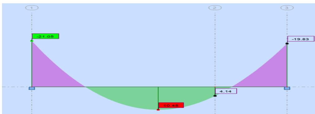
**Figure V.5 :** Sollicitations escalier.**V.2.2 Le ferraillage :**
