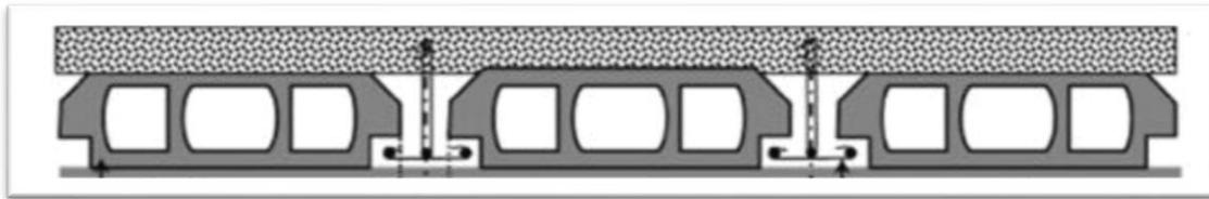
**Figure II.1** : Coupe du plancher à corps creux
