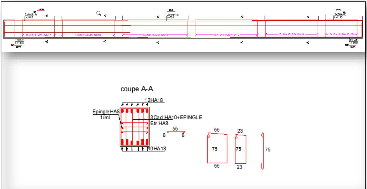
Figure VI.8 : Ferrailage nervure
