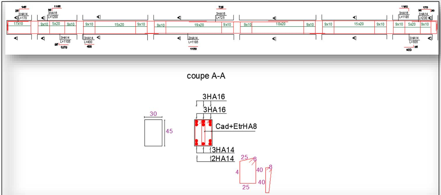
Figure IV.7: Ferraillage poutre principale étage courant.
