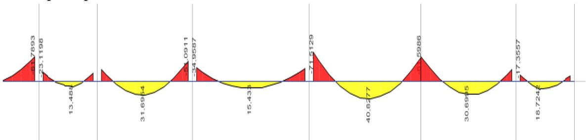
Figure IV.1 : Diagramme des sollicitations dans les poutres principal (étage courant)
