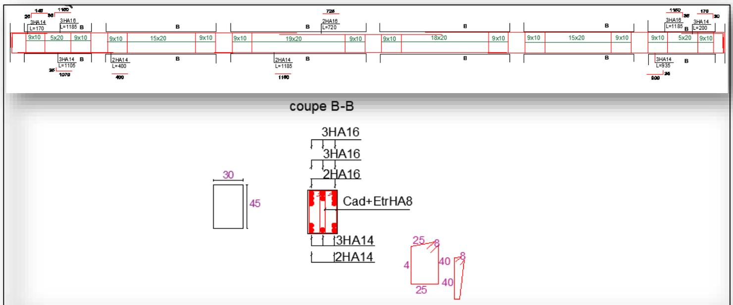
Figure IV.8: Ferrailage poutre principale RDC.
