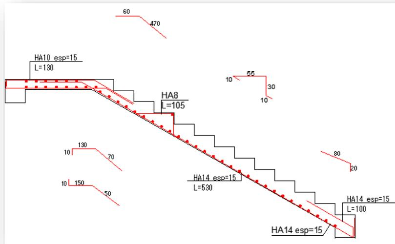
Figure V.6 : Ferrailage volée 1.
