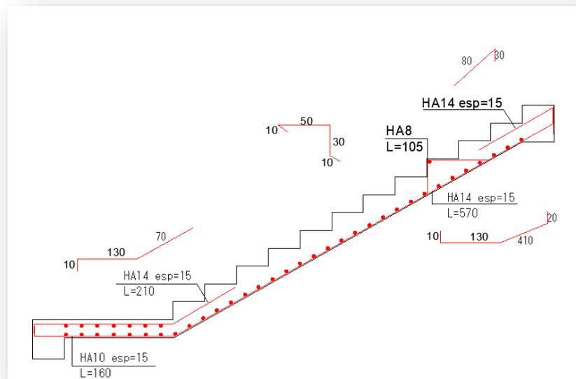
Figure V.7 : Ferrailage volée 2.
