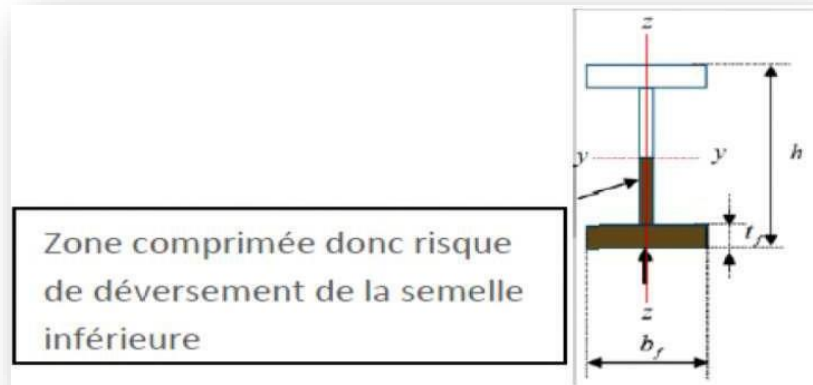
Figure III.4. Représentation de phénomène de déversement dans la semelle inférieure.
