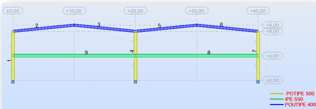
Figure. VII.3. Portique ferme avec repérage des barres.
