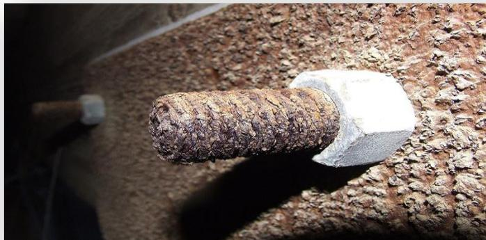
**FigureXI.2. Corrosion différentiée sur deux métaux plus et moins oxydables.**
