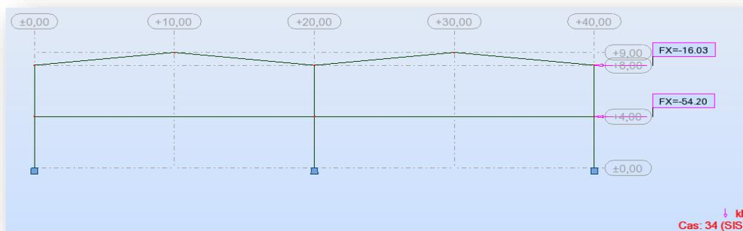
Figure.VII.10. Présentation de la charge sismique sur le portique.
