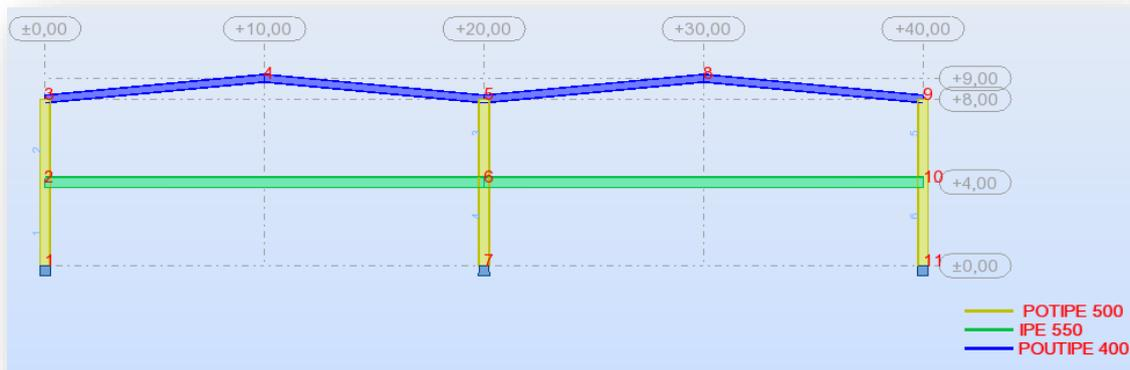
Figure.VII.2. Portique ferme avec repérage des nœuds.
