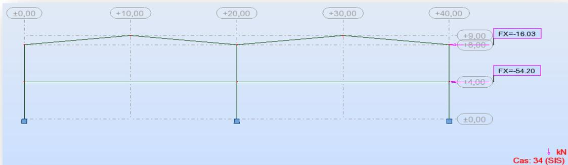
Figure.VI.3. Distribution des forces sismique par portique mixte (sens transversal)
